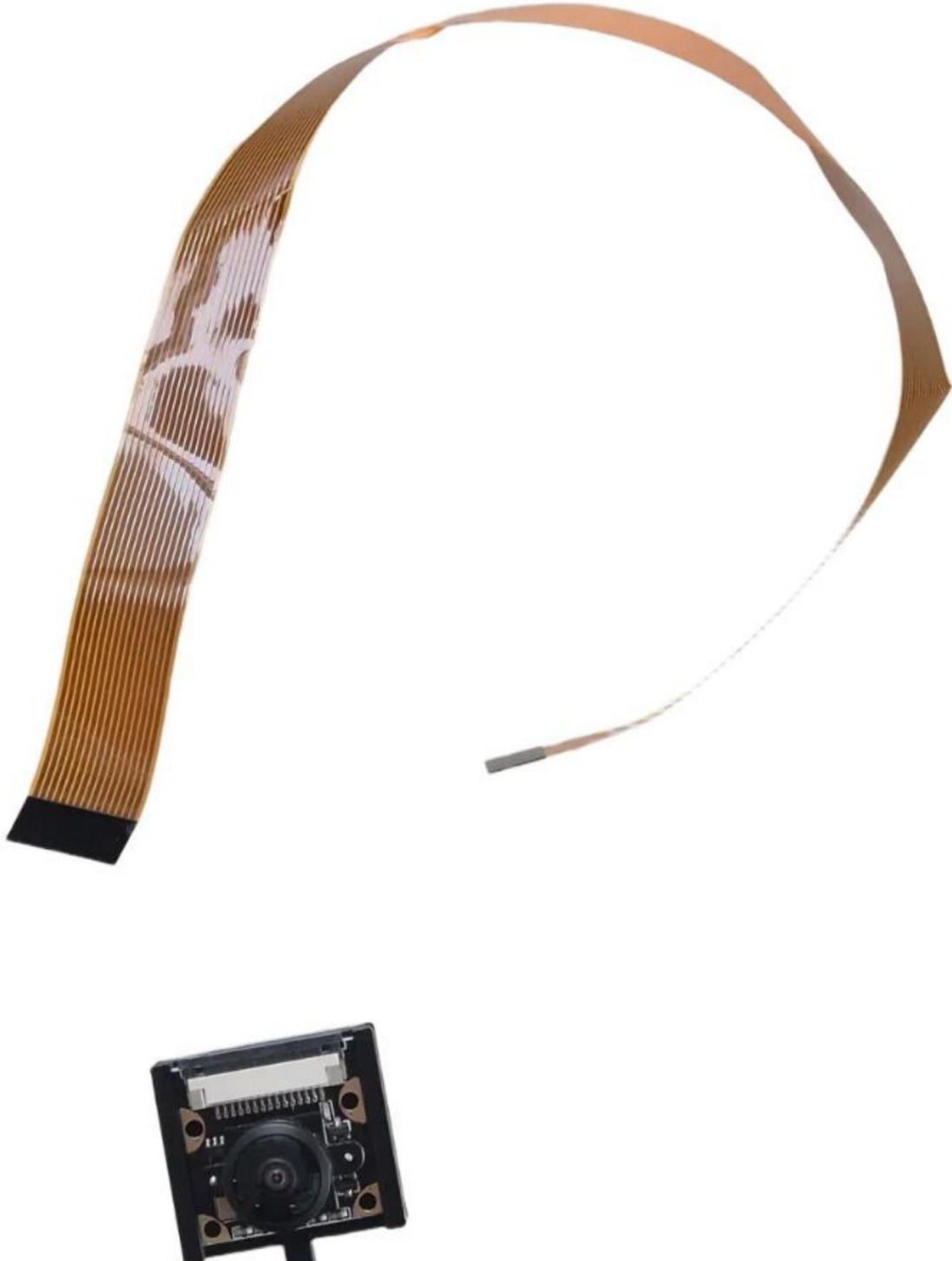
그림 3-21 카메라 모듈과 카메라 케이블
